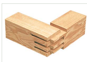
Rohové styčné plochy jsou spojeny třídílnými čepy, které zajišťují nejvyšší stabilitu prostřednictvím navýšení lepených ploch o 40 %.
