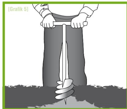
Punktfundamente einmessen, z.B. mit Erdbohrer ausheben oder mit Spaten rechteckig abstechen. Die Fundamentgröße richtet sich nach den örtlichen Gegebenheiten und muss den statischen Erfordernissen entsprechend objektbezogen eigenverantwortlich bestimmt werden.
